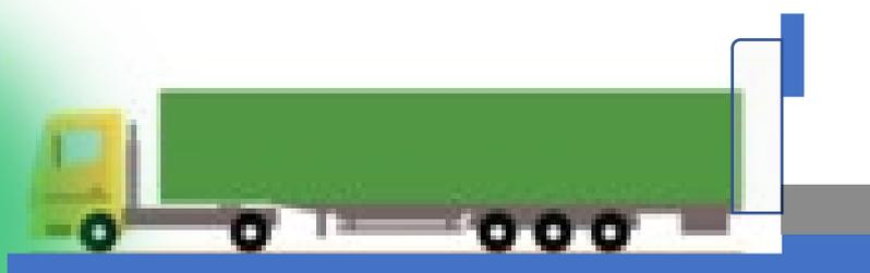
**B** La soluzione oggi piu' utilizzata. Il camion e' esterno all'edificio e accosta contro la banchina. Il transito dei mezzi e le operazioni possono essere protette con pensilina e portale isotermico. In presenza di magazzini a temperatura controllata occorre prestare piu' attenzione al tipo di sigillante e alle modalita' operative delle fasi di carico e scarico. Vedere l'apposita sezione.
