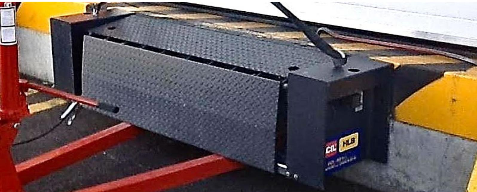
Questa innovativa pedana a funzionamento esclusivamente manuale consente di risolvere in modo economico parecchie necessita' di raccordo del piano banchina con il piano del mezzo.
