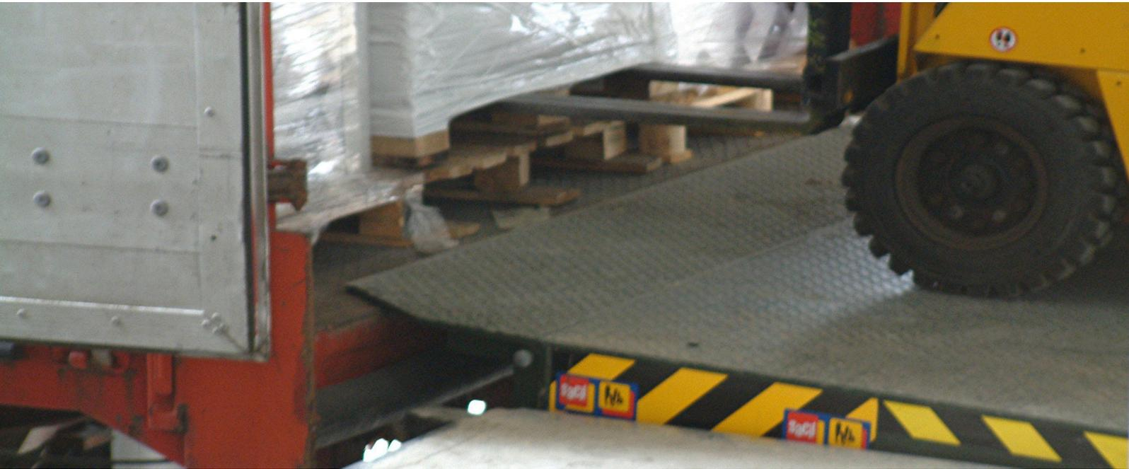
Tutti i modelli idraulici che presentano la sigla **PA2P** all'interno del nome del modello sono dotati di becco frontale a rotazione.
